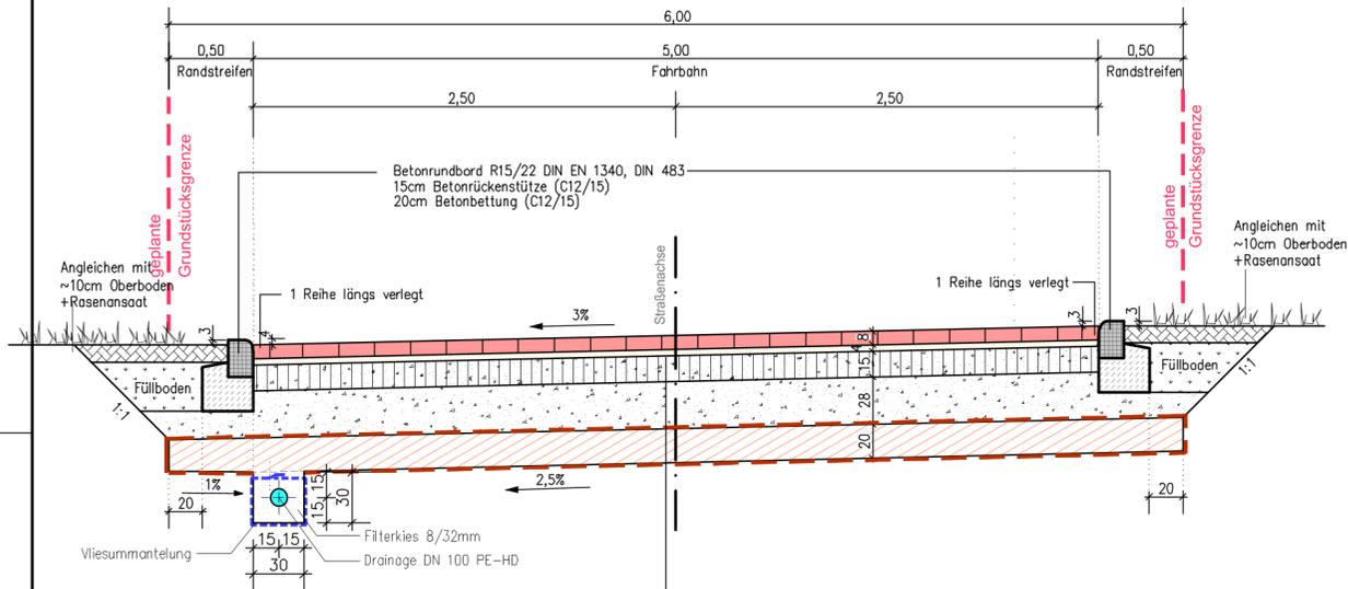
Aufbau Fahrbahn (entspr. Belastungsklasse 0,3 der RSTO 12 Tafel 1, Zeile 3)
