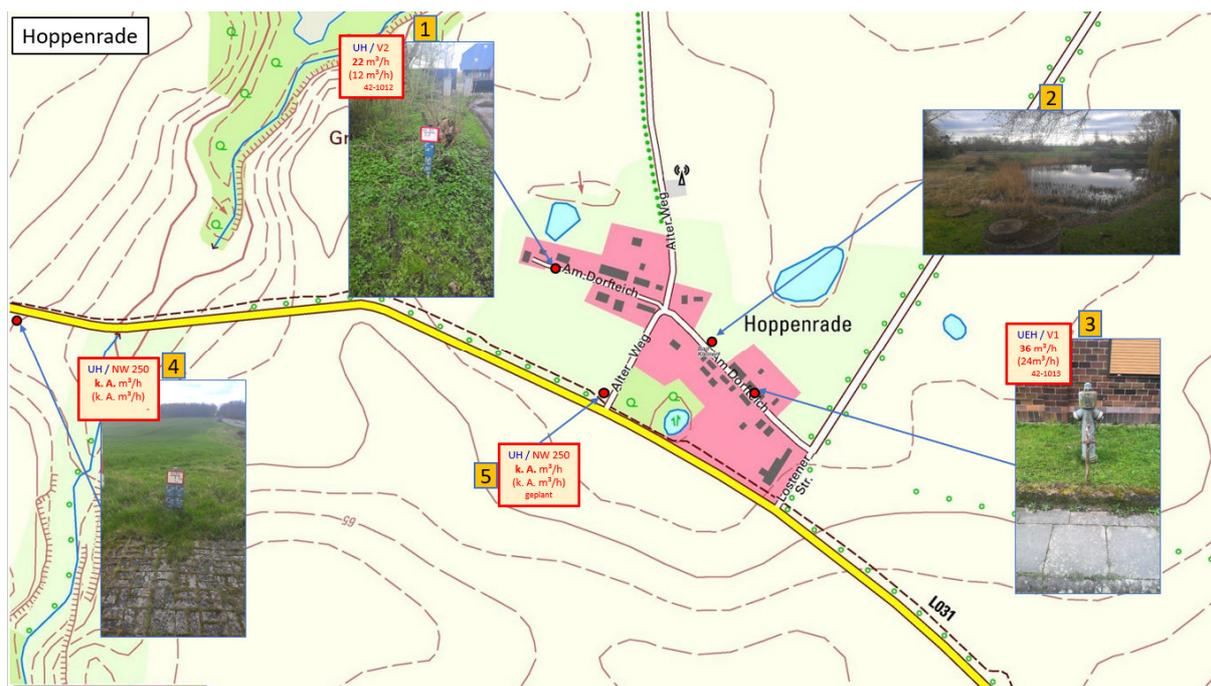
Abbildung 8 Löschwasserentnahmestellen Ortsteil Hoppenrade [1]
