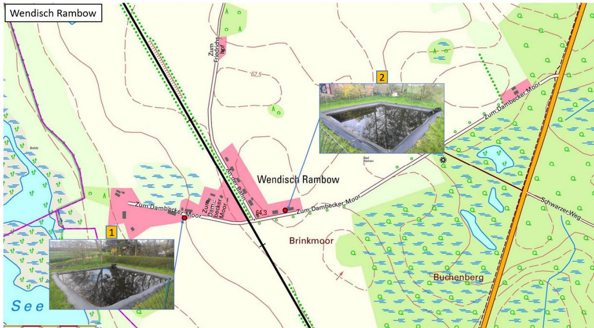
Abbildung 13 Löschwasserentnahmestellen Ortsteil Wendisch Rambow [1]
